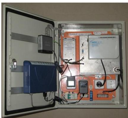
Рис. 7. Полевой пункт системы СССМ для подземной установки
