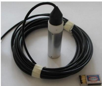
Рис. 5. Сейсмоприемник для скважинной установки
